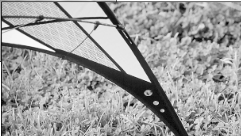
▲ Die Turbolator Holes in der Flügelspitze sollen eine gleichmäßige Fluggeschwindigkeit, verbesserte Stalleigenschaften und größere Präzision bewirken.
