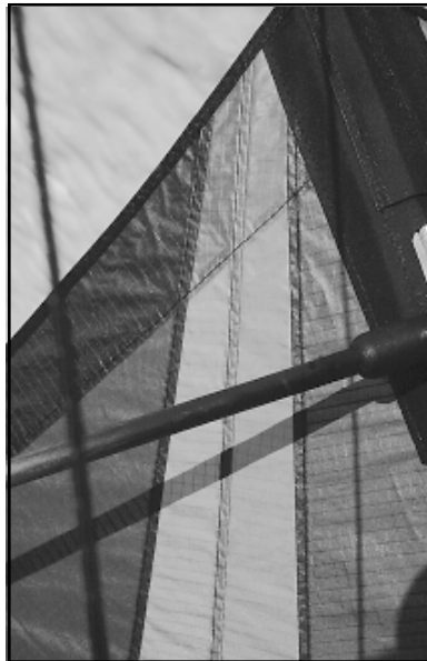
Saubere Verarbeitung: Vernähte Paneele im Kielbereich des Segels.
