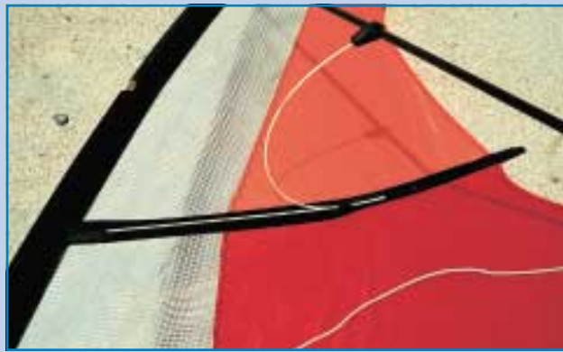
Die umgebogenen GFK-Stäbe geben dem Segel Steifigkeit und Profil.
