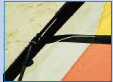
▲ Auch die äußeren Segellatten werden mit HQ-„Gummibärchen“ an den unteren Querspreizen befestigt.
